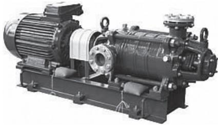
Насосы типа ЦНС (г, к, н, м) - центробежный, горизонтальный, секционный, однокорпусный, многоступенчатый, с односторонним расположением рабочих колес, с автоматической разгрузкой осевого усилия ротора, гидравлической пятой, с подшипниками скольжения, с приводом от электродвигателя.
